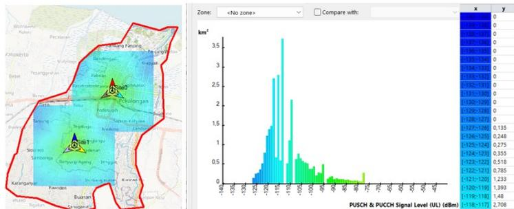
Figure 7. Hasil Parameter RSRP MU-MIMO (a) pada Area Pekalongan (b) pada Histogram di Kota Pekalongan
