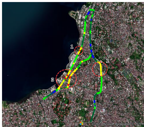
Gambar 5. Hasil Drive Test RSRP Sebelum Optimasi
