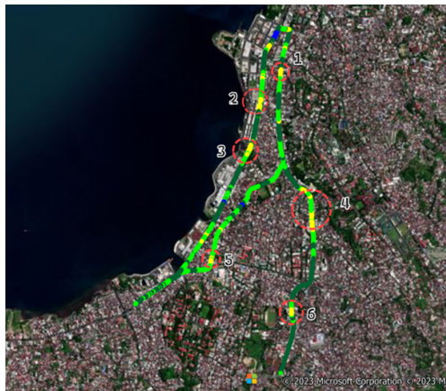
Gambar 6. Hasil Drive Test SINR Sebelum Optimasi
