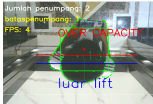
Gambar 9. Tahap Mencari Titik Centroid serta Jumlah piksel untuk di lacak
